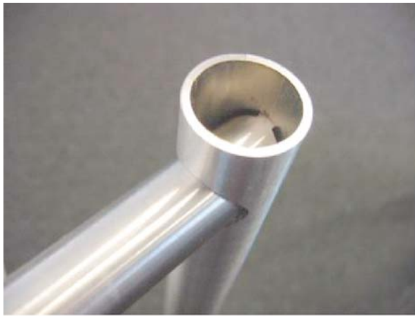
Superposición y encastre de tubos
