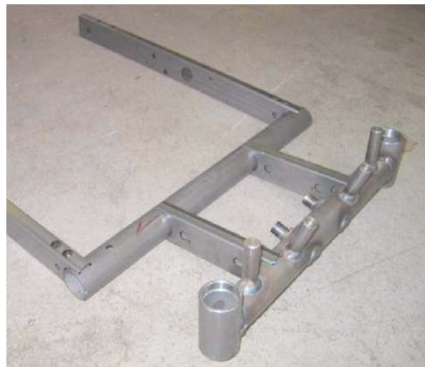
Conexión de diferentes perfiles de tubos y tipos de piezas
